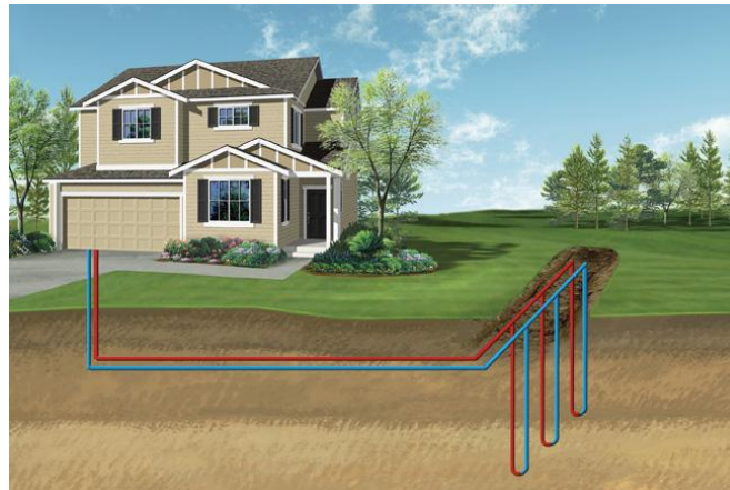
řekil 3.3 Dikey sondaj uygulamaları [4]
