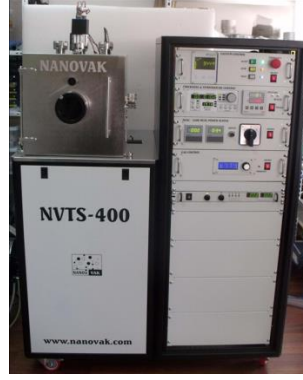
Şekil 7-8 Nanovak Sputter+Termal Kaplama Cihazı.
