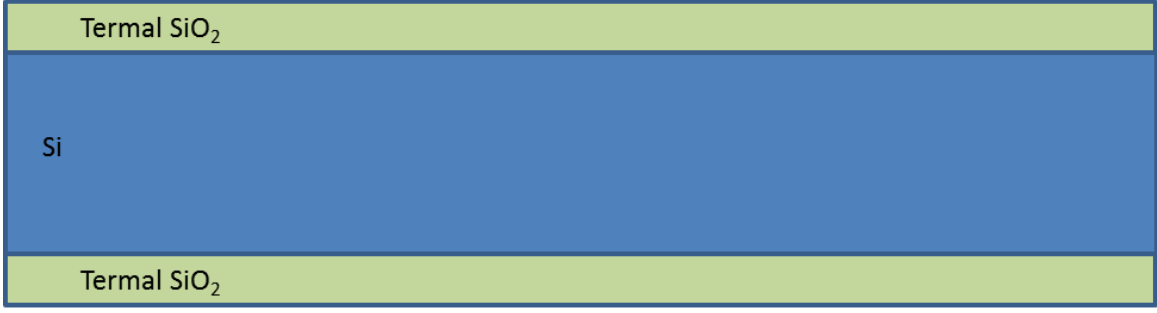
Şekil 6-5 Termal oksit büyütülmüş silisyum alttaş kesit şematiği
