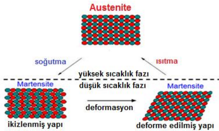
Şekil 2.19. Şekil hafıza etkisinin şematik gösterimi
