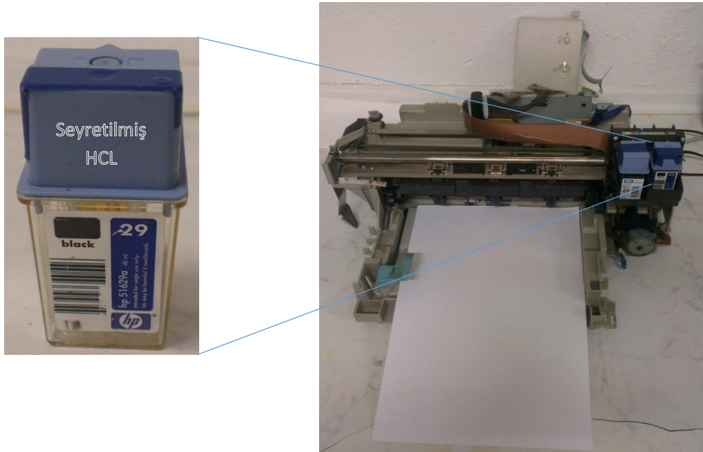
Şekil 3.4. Hidrofilik kanallar oluşturmak için HP 29 kartuşun kullanması
