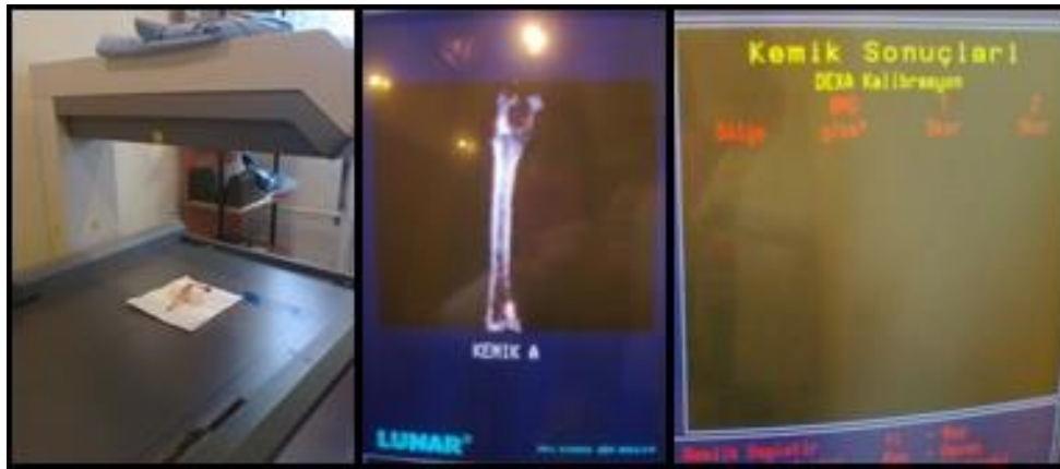
Şekil 6. Deneye katılan tavşanların Lunar DPX DXA cihazı ile kemik mineral yoğunluğu ölçümü
