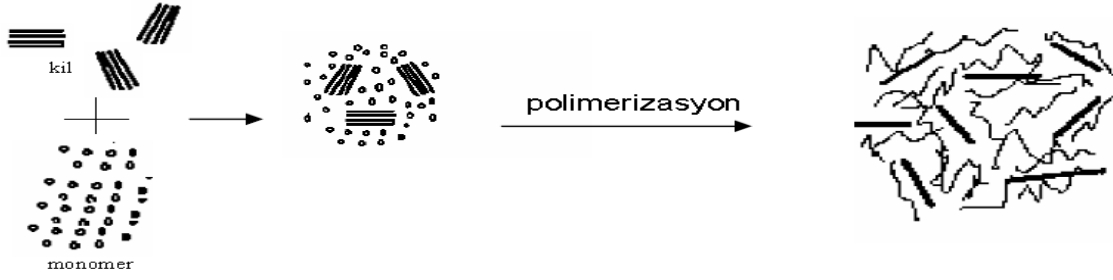
Şekil 2.4. Kil/polimer nanokompozitinin polimerizasyon yöntemi ile hazırlanmasının şematik gösterimi
