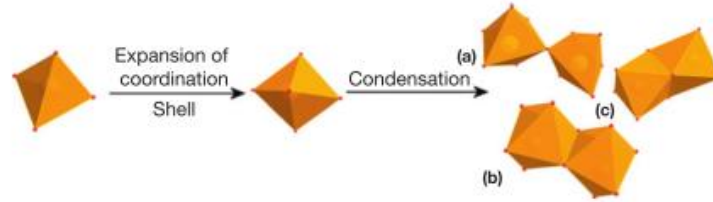
Şekil 2.6. POM kümelerinin oluşumu. POM kümelerinin a) köşe paylaşımlı b) kenar paylaşımlı ve c) yüzey paylaşımlı birleşimleri [96].
