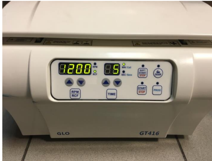
Şekil 3.14. 5 dakika boyunca 1200 devirde santrifüj edilmesi.
