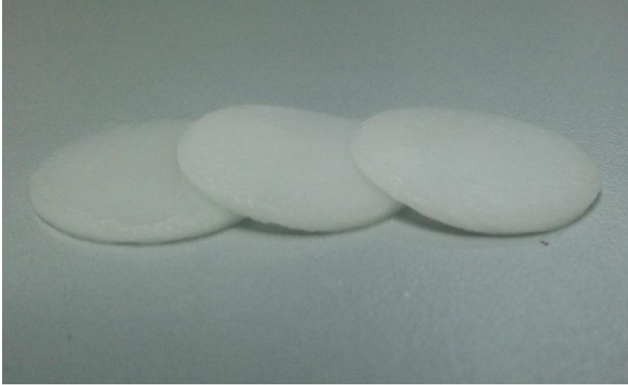
Şekil 2.8. Kartuş şeklinde hazırlanan Poli(HEMA/MAPA) süpermakrogözenekli membran kriyojel.
