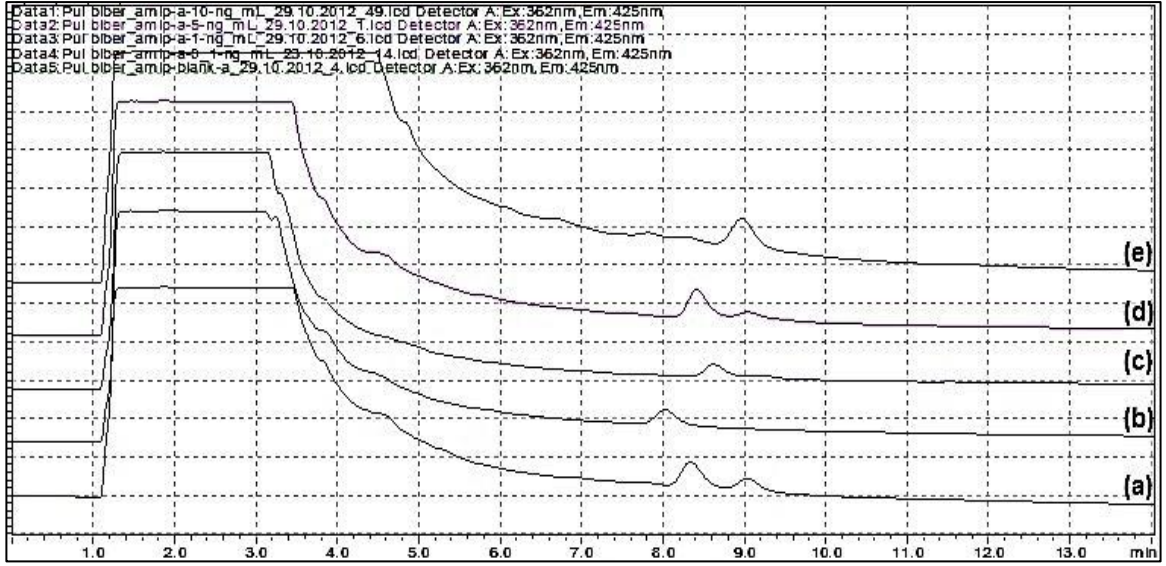
Şekil C.25. Gerçek örneklerden aflatoksin özütlenmesi (Bölüm 4.7): AflaMIP-4 kompozit kriyojel. Numune: Çeşitli derişimlerde aflatoksin standard karışımı eklenmiş pul biber özütlemesi. Adsorpsiyon eflüatı HPLC kromatogramları; (a) Düşük derişimde aflatoksin içeren numune, (b) 0.1 ng/mL, (c) 1.0 ng /mL, (d) 5.0 ng/mL, (e) 10 ng/mL.
