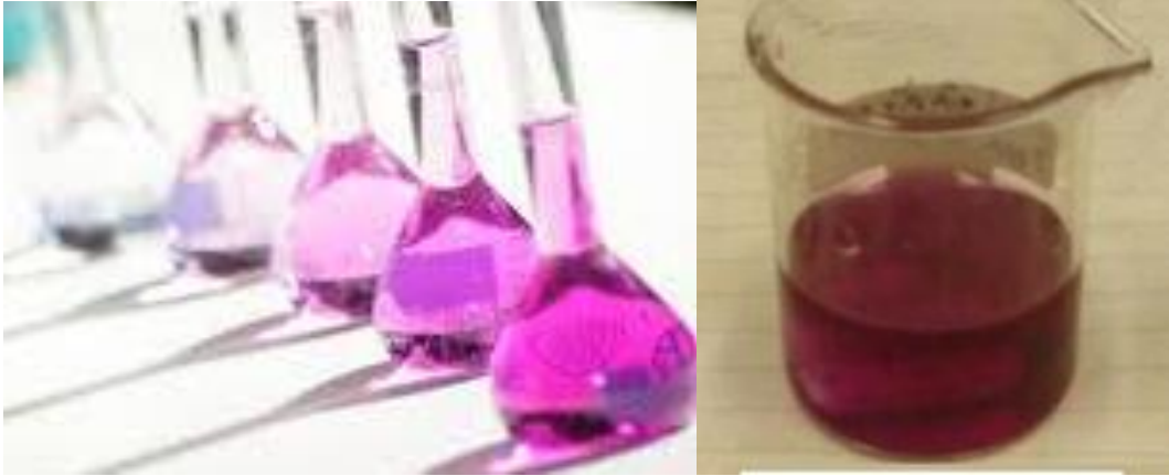
Şekil 4.10. APR' den alınan numunelerde Cr(VI) ölçümü sırasında meydana gelen renk deęişimi
