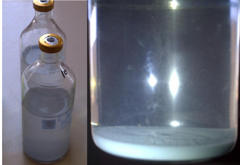
Şekil 4.11. Kesikli reaktörlerde Cr(VI) indirgenmesi ve oluşan Cr(OH) 3 çökeleği
