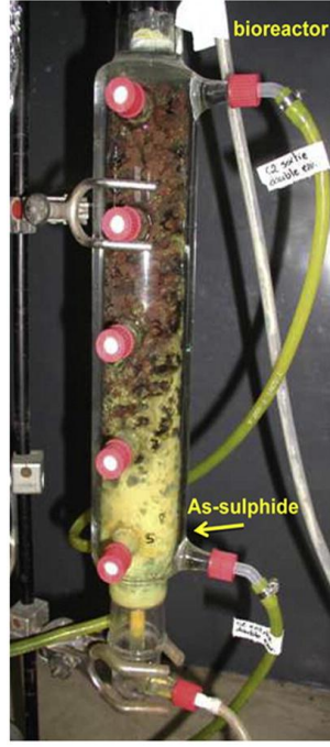
Şekil 2.8. Battaglia-Brunet ve arkadaşları tarafından yapılan çalışmada reaktörde sarı renkli orpiment ( As_2S_3 ) birikimi [120]
