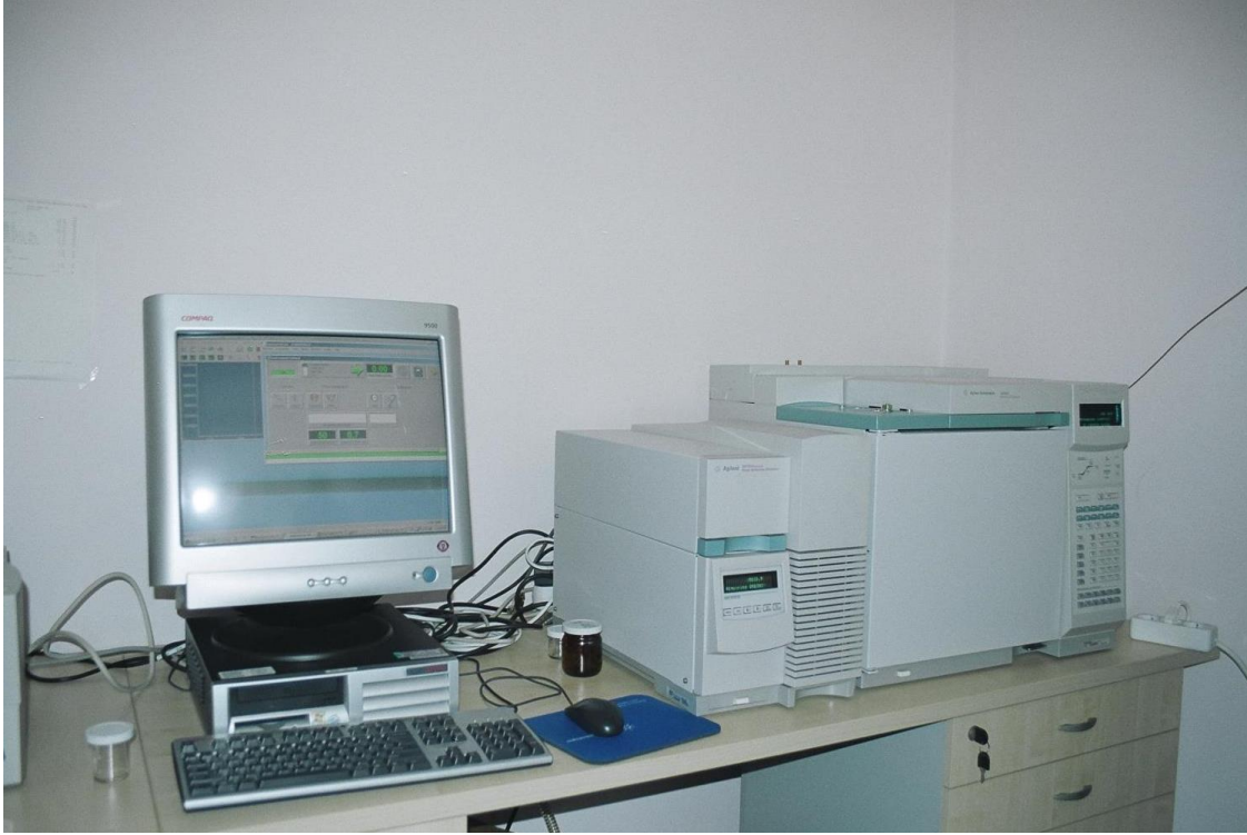
Şekil 3.7. GC-MS cihazı (Hacettepe Üniversitesi Biyoloji Bölümü Palinoloji Laboratuvarı) (Fotoğraf: Ömür Gençay Çelemlı)
