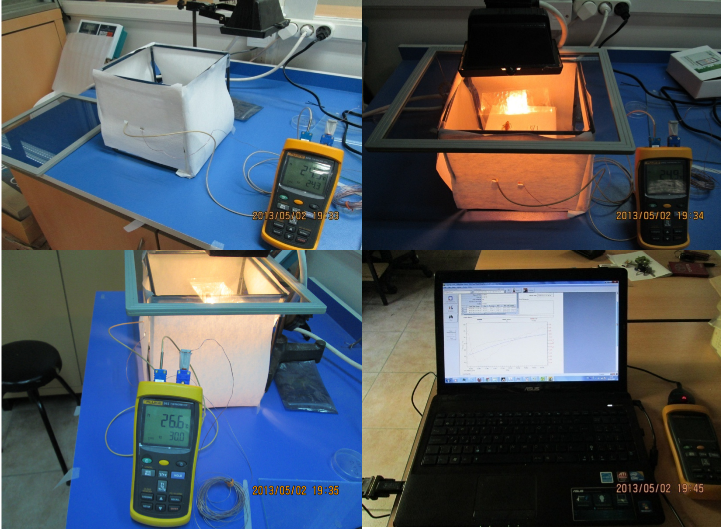
Şekil 1.8. Sıcaklık kapasitesi ölçümleri ve verilerin bilgisayara aktarılması.
