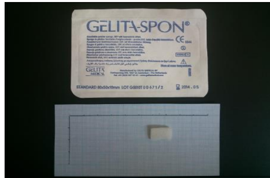
Şekil 3.2 2 1 \times 1.5 \text{ cm}^2 boyutunda hazırlanan jelatin matriksler.
