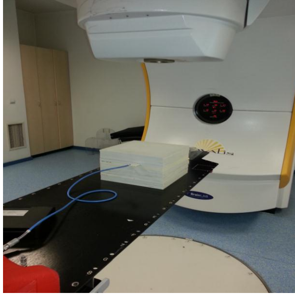
Şekil 3.18. Novalis sistemindeki ölçümün set-up görüntüsü
