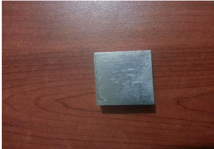
Şekil 3.13. 30x30x10 mm boyutlu Ti-6Al-4V cerrahi implant materyali
