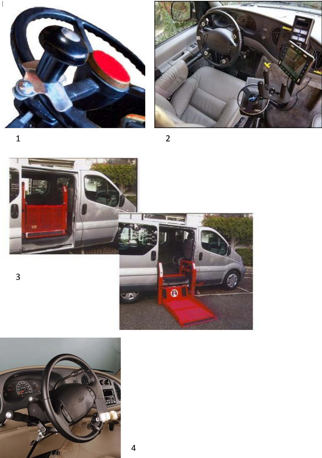
Şekil 2.3. Dünyada Kullanılan Yardımcı Teknoloji Örnekleri; 1: Kavrama yardımcısı, 2: Üst ekstremité kontrolü ise araba kullanımı için bilgisayar destekli araba paneli, 3: Tekerlekli sandalye ile araç içine mobilizasyon sağlanabilmesi için ayarlanabilir rampa; 4: Sağ üst ekstremité için kavrama yardımcısı
