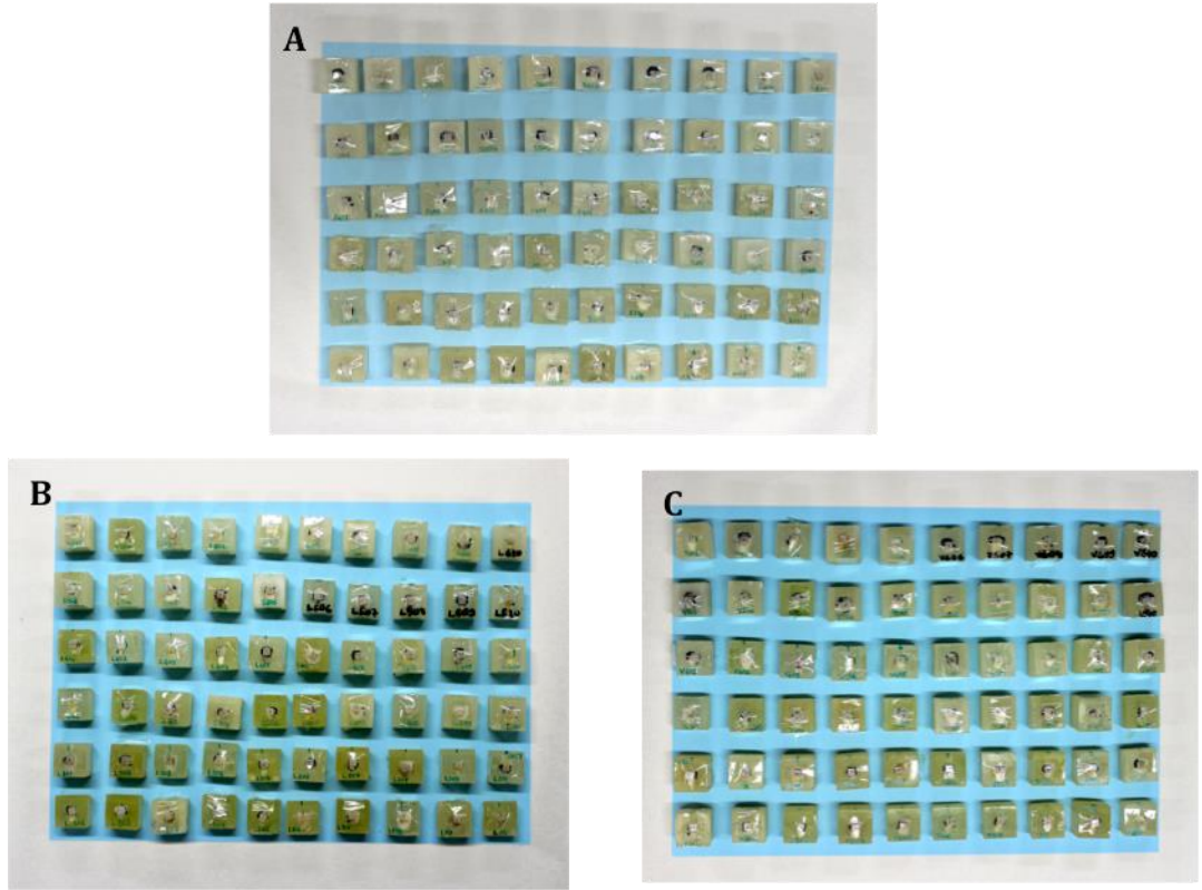
Şekil 3.5. Akirlik bloklara gömülmüş örnekler: A) SC örnekleri B) LU örnekleri C) VE örnekleri.
