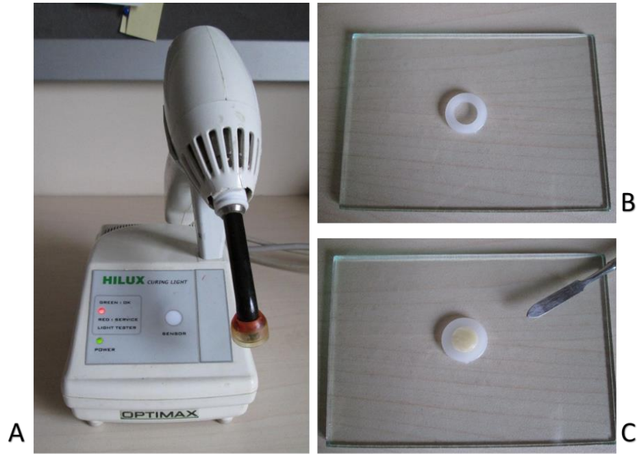
Şekil 3.4. A) Çalışmada kullanılan halojen ışık kaynağı B) Disk şeklindeki örnekleri hazırlamak için kullanılan silikon halka C) Materyalin kalıba yerleştirilmesi.
