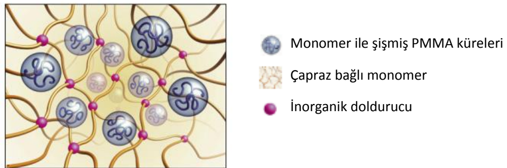
Şekil 2.7. Vita Cad-Temp'in yapısı
