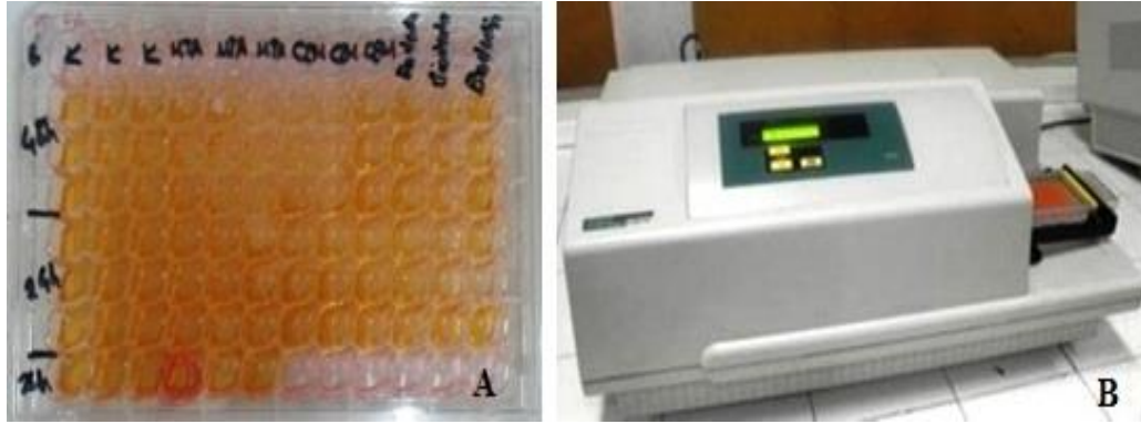
Şekil 3.21. A. Kuyulara WST-1 eklendikten sonraki görünüm B. Absorbans değerlerinin belirlendiği mikro-ELISA okuyucu.
