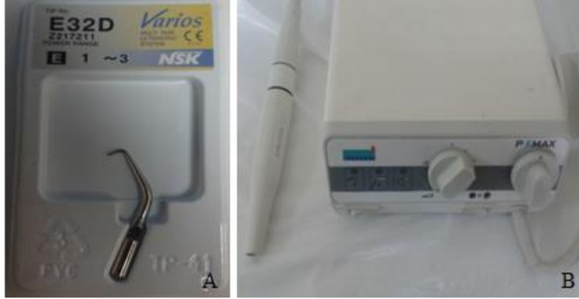
Şekil 3.2. A. Kök ucu kavitesi hazırlanmasında kullanılan ultrasonik uç, B. Ultrasonik cihazın görünümü.
