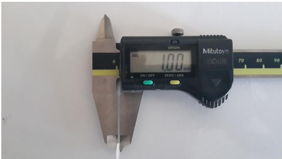
Şekil 3.2.3.4: Kesit kalınlıklarının dijital kumpas ile ölçülmesi
