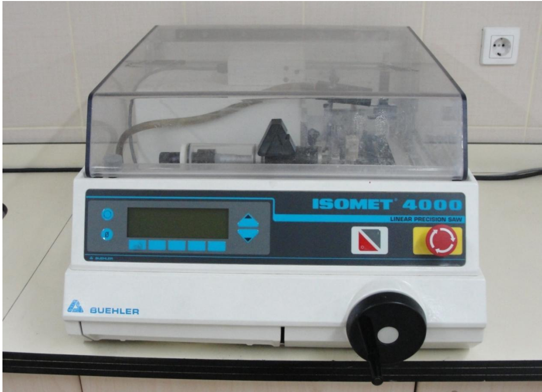
Şekil 3.2.3. 3: Örneklerden kesit almada kullanılan ISOMET 4000 cihazı
