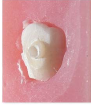
Şekil 4.4.4.2. Mine örneklerinin %36'sında görülen kırılma tipi kohezivdir. Bu örneklerde adezyon daha güçlü gerçekleşmiştir.
