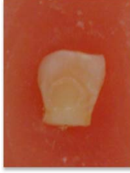
Şekil 4.4.4.5. Dentin örneklerinin %30,66'sında görülen başarısızlık tipi kohezivdir. Kompozitin dentine oldukça güçlü bağlandığı söylenebilir.
