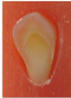
Şekil 4.4.4.4. Dentin örneklerinin %61,33'ünde adeziv tip başarısızlık izlenmektedir. Bu durum dentine bağlanmanın zayıf olduğunu gösterir.
