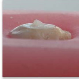
Şekil 4.4.4.6. Dentin örneklerinin %8'inde karma tipte kırılma gözlenmiştir. Adeziv ve koheziv kırılmanın beraber görüldüğü bu örneklerin dentin dokusuna iyi bağlandığı söylenebilir.
