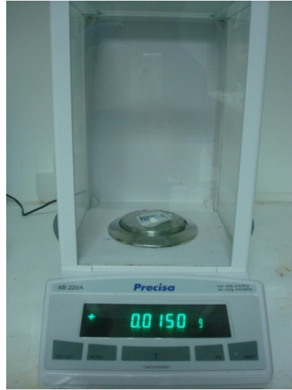
Şekil 3.3.1. Fonksiyonlaştırılmış TiO 2 nanotüplerin hassas terazi ile tartılması
