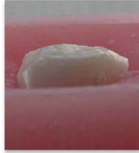
Şekil 4.4.4.3. Mine örneklerinin %12'sinde karma başarısızlık gözlenmiştir. Kompozit materyal mine dokusuna iyi bağlanmıştır.
