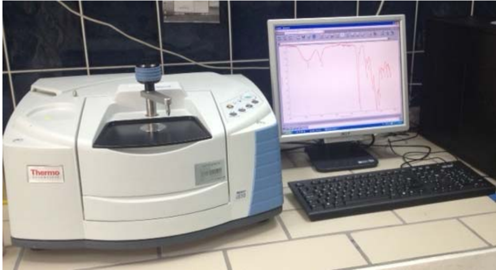
Şekil 3.2. FTIR spektrometresi ile fonksiyonel grupların karakterizasyonu
