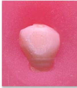
Şekil 4.4.4.1. Mine örneklerinde %52 adeziv kırılma tipi gözlenmiştir. Adeziv kırılma örneklerin kompozite daha zayıf bağlandığını gösterir.
