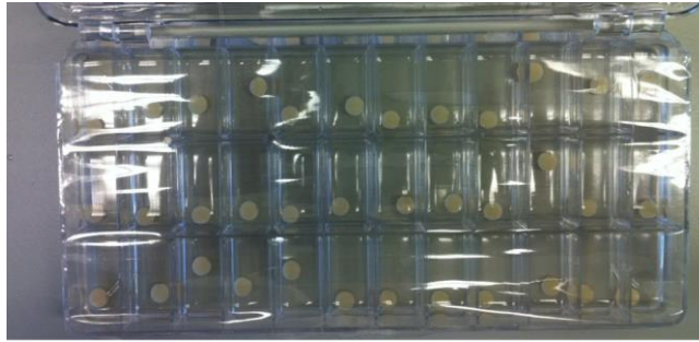
Şekil 3.8. Etüv içerisinde distile suda bekletilen kompozit rezin örnekler
