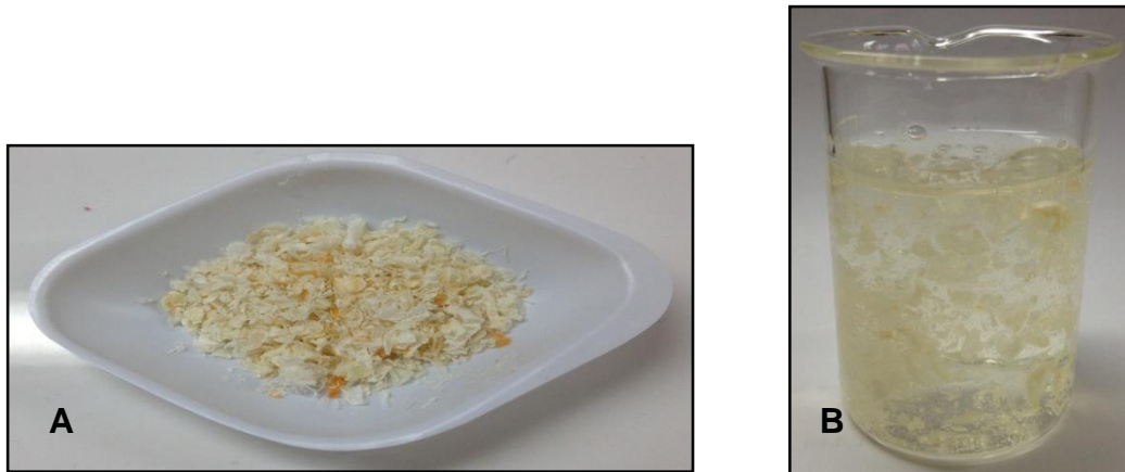
Şekil 3.1.1. A: Yüksek molekül ağırlıklı kitosan; B: Laktik asit çözeltisi içinde kitosan
