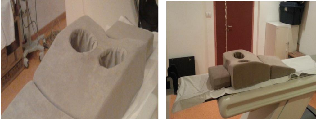
Resim 3.1. Yüzüstü görüntüleme için kullanılan ve bu çalışma için özel olarak yaptırılan meme yastığı
