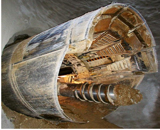
Şekil 24. İtme silindirli GAM (Tunneltalk, 2019).
