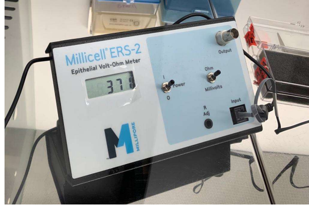
Şekil 3.2. Millicell ERS-2 TER ölçüm cihazı ve ölçüm yöntemi
