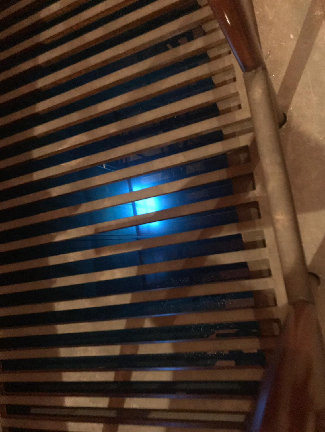
Şekil 5.20. Su içerisinde muhafaza edilen gama ışıma kaynağı, ^{60}\text{Co}
