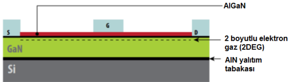
Şekil 3.6. Tükenim modlu GaN tranzistörlerin iç yapısı
