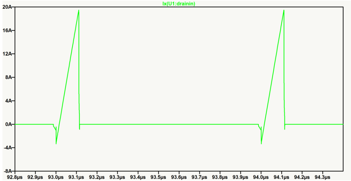
Şekil 4.31. Tam yük altında yüksek taraf tranzistörünün ( Q_1 ) akım dalga şekli
