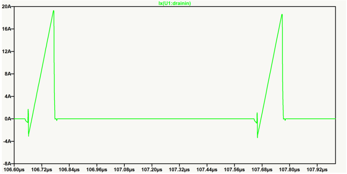
Şekil 4.44. Tam yük altında yüksek taraf tranzistörünün ( Q_1 ) akım dalga şekli
