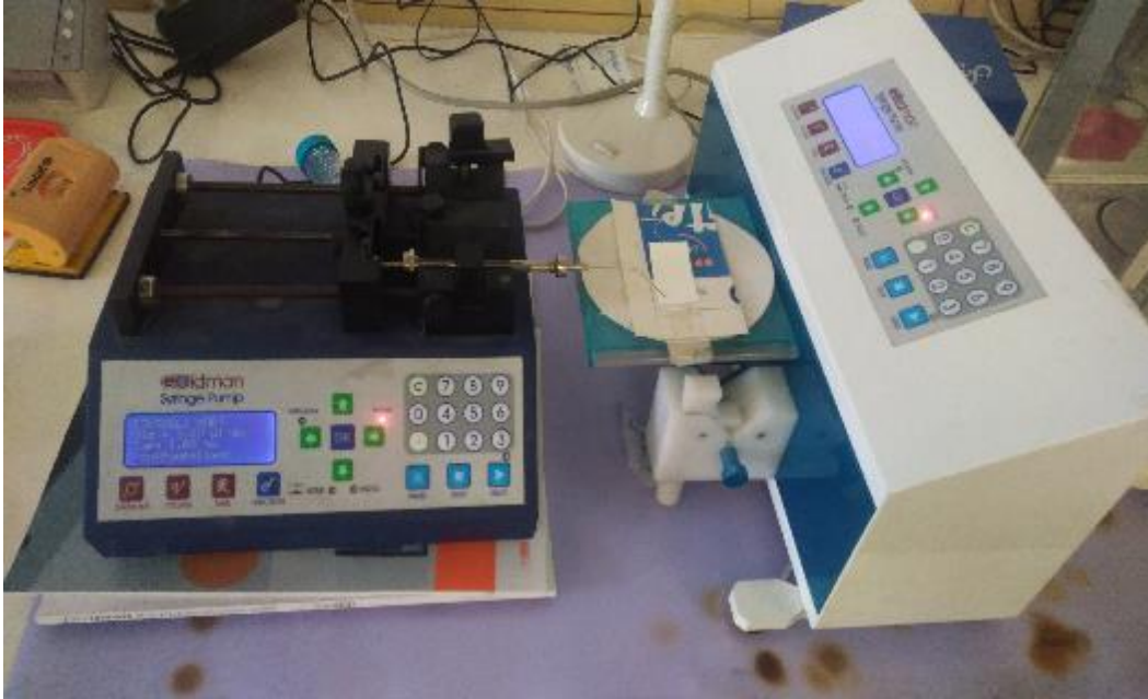
Şekil 3.6. Nitroselüloz membran üzerine antikor çizgilerinin oluşturulması için kullanılan ikili enjektör şırınga sistemi.
