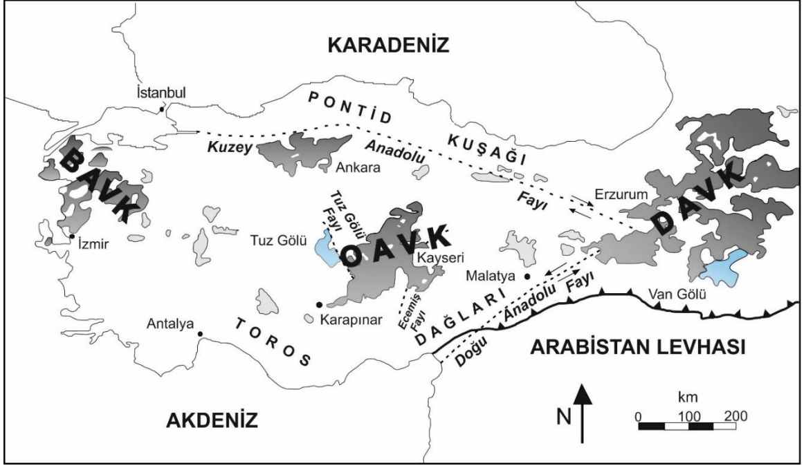
Şekil 3.3. Türkiye'nin ana yapısal özellikleri (Le Pennec ve ark., 1994'ten değiştirilerek alınmıştır). Gri renkli kısımlar, yaşları Oligosen ile Kuvaterner arasında değişen volkanizmayı temsil etmektedir. OAVK: Orta Anadolu Volkanik Kuşağı. DAVK: Doğu Anadolu Volkanik Kuşağı. BAVK: Batı Anadolu Volkanik Kuşağı.
