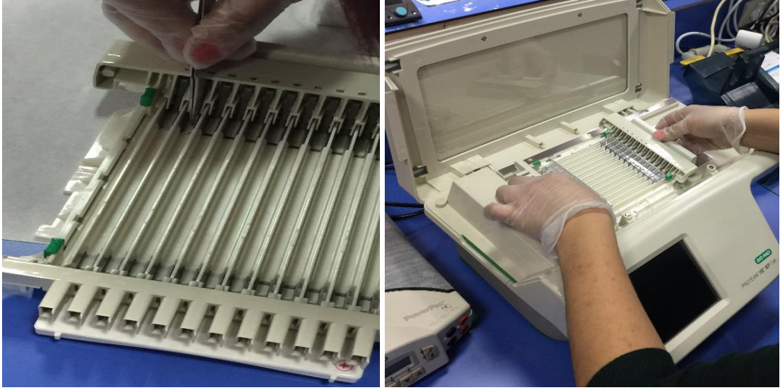
Şekil 2.14. Rehidrasyon tekniği ile IPG şeritlerine yüklenen proteinlerin bulunduğu odaklama tablasının IEF cihazına yerleştirilmesi (Birinci Boyut).
