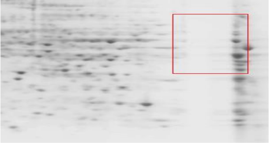
Şekil 5.10. Karışan maddeler; rehidrasyon / numune çözeltisinde safsızlıklar sonucu oluşan (kırmızı kare içinde kalan alan) jel görüntüsü 3 .
