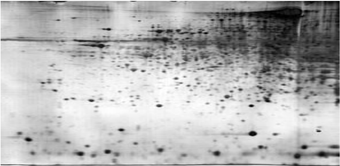
Şekil 5.14. Yetersiz temizleme/yıkama süreçleri sonrası sonucu oluşan jel görüntüsü 3 .
