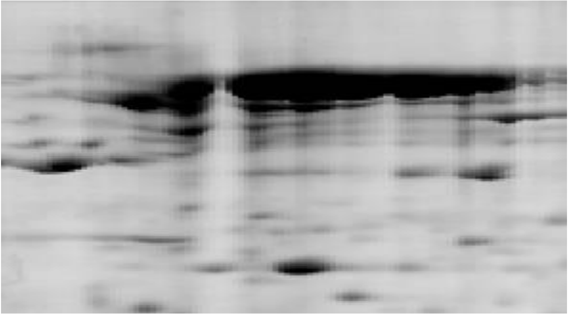
Şekil 5.8. IPG şerit ve ikinci boyut jel arasında sıkışan hava kabarcıkları sonucu oluşan jel görüntüsü 3 .
