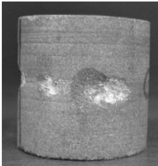
Şekil 2.5. Nokta yük deneyinde görülen lokal kırıklar [18].
