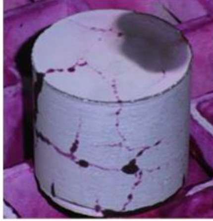
Şekil 2.10. 60s mikrodalgaya maruz bırakma sonrası gelişen çatlaklar [23].
