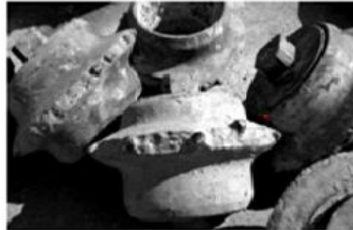
Şekil 1.5 Keski bozunması ve gövdede oluşan deformasyonlar [1]
