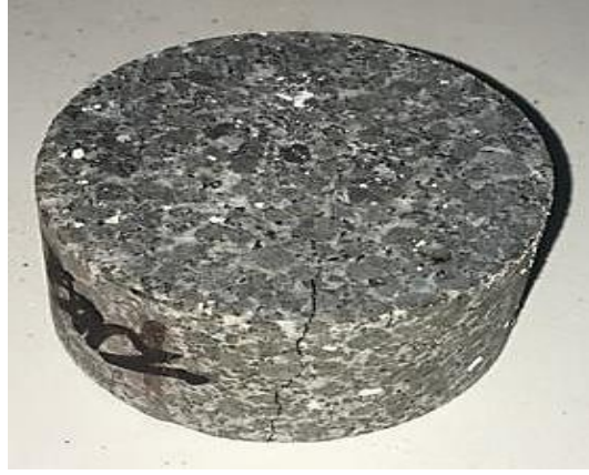
Şekil 5.10. Nero Turka (Gabro)numunesinin mikrodalgaya maruz bırakıldıktan sonra çatlaması.
