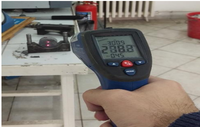
Şekil 4.10. Numunelerin ısı derecelerinin kızılötesi termometre ile ölçülmesi.
