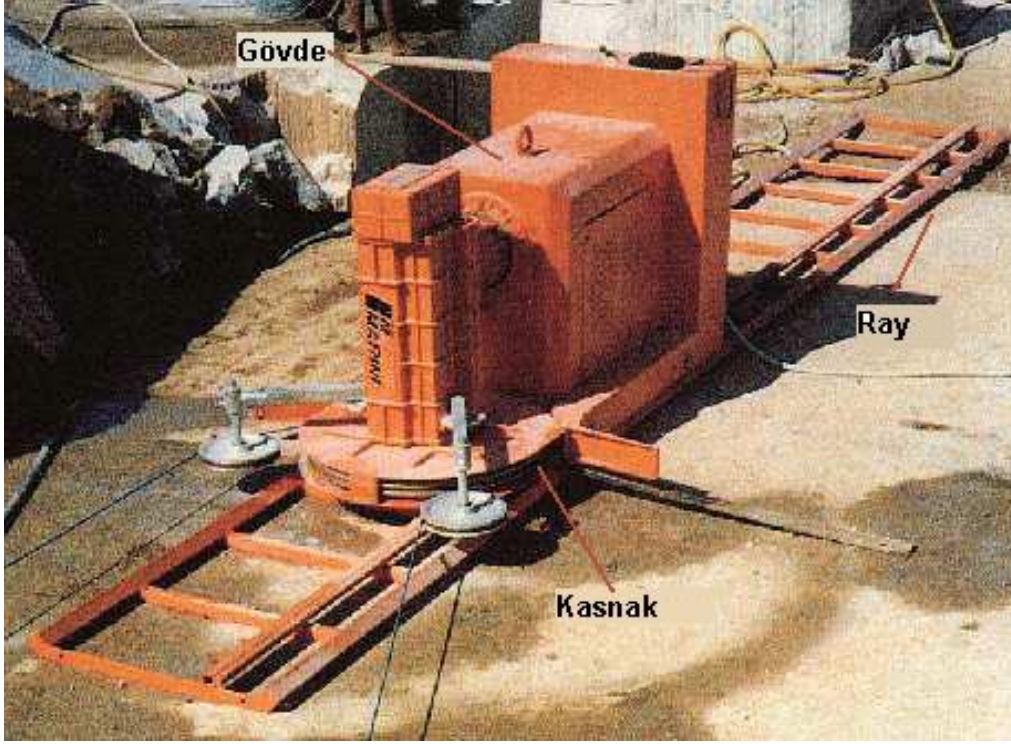
Şekil 2.2. Elmas telli kesme makinesi
