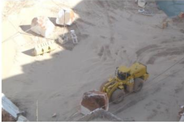
Şekil 2.10. Lastik tekerlekli kepçe ile blok yüklemesi
