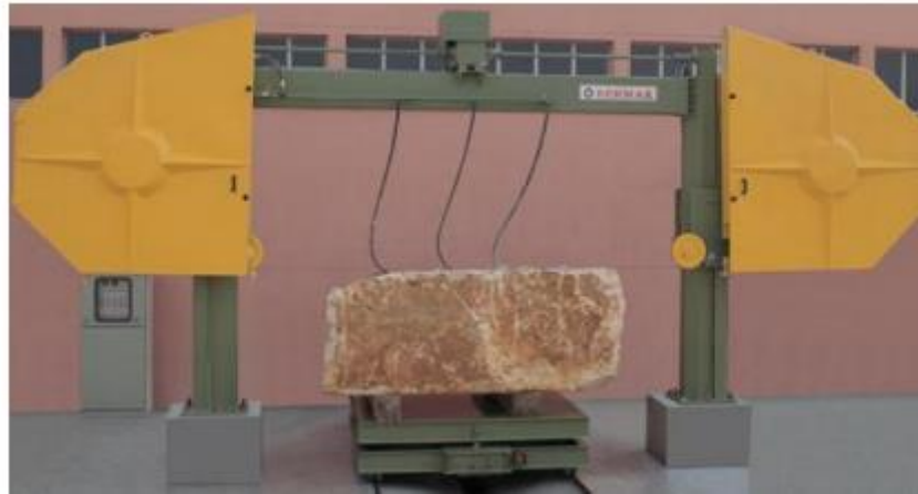
Şekil 2.8. Metal ayaklar üstünde zemine sabitlendirilmiş elmas telli kesme makinesi
