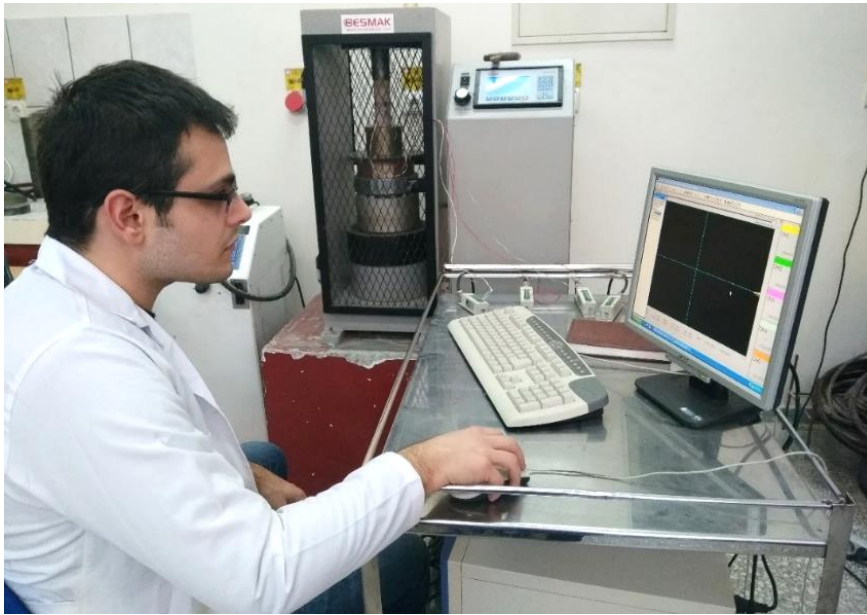
Şekil 4.9. Elastisite modülünün tayini için kullanılan bilgisayar kontrollü deney düzeneği ve deneyin yapıışından bir görünüm
