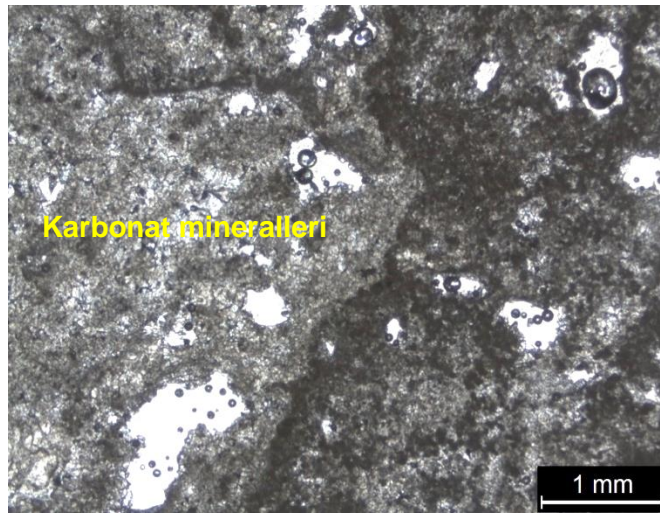
Şekil 3.4. Travertende (Örnek No. 3) (a) sık aralıklarla tekrarlanan tabakaların genel ve (b) yandan ve (c) kayacın tek nikolde görüntüsü
