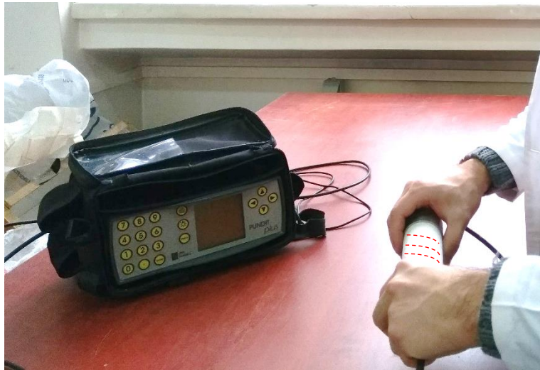
Şekil 4.3. P-dalga hızı ( V_p ) deney düzeneği ve deneyden bir görünüm
