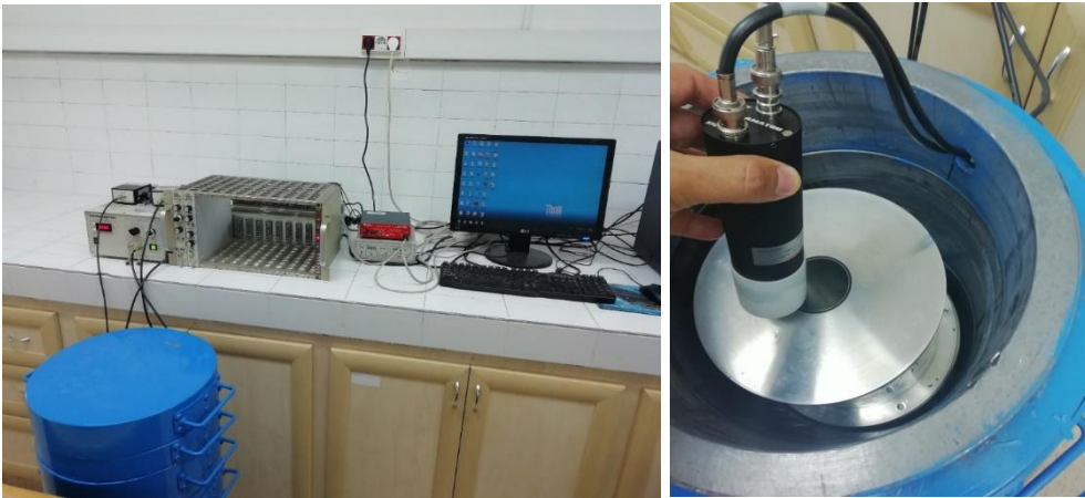
Şekil 4.2. Bu çalışmada kullanılan dijital 4\pi\beta\text{-}\gamma sayım sistemi.
