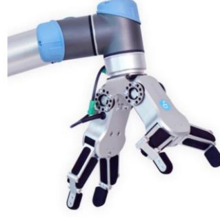
Şekil 4.2. Esnek robotik hücrelerde kullanılan çift kısıkaç örneği 3
