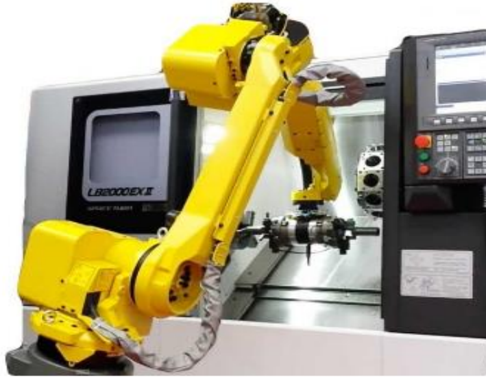
Şekil 2.4. Robotun CNC makineyi beslemesi 2
