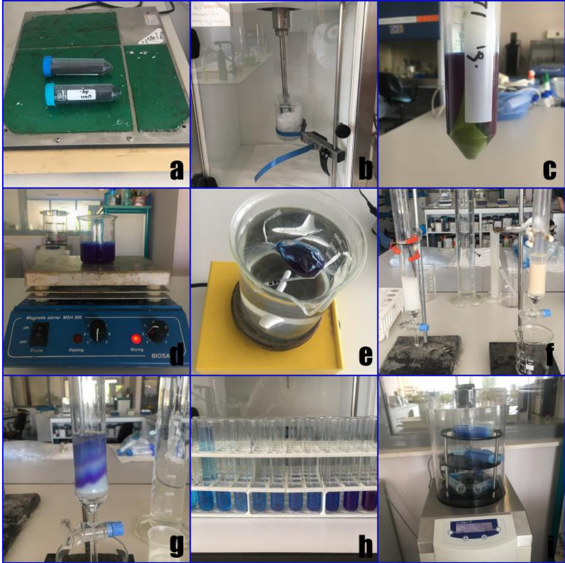
Şekil 3.4. C-Fikosiyanin saflaştırma aşamaları. a) İnkübasyon, b) Sonikasyon, c) Santrifüj, d) Amonyum sülfat tuzu ile doyurma, e) Diyaliz, f) Sephadex G50 kromatografisi ve DEAE selüloz iyon değiştirme kromatografisi g) DEAE selüloz iyon değiştirme kromatografisi ile saflaştırma, h) Toplanan fraksiyonlar, i) Liyofilizasyon.
