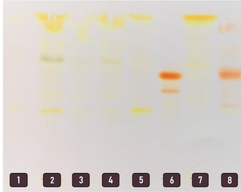
Şekil 4.1. Karotenoit karışımları ve standart bileşiklerin ince tabaka kromatogramı. 1. Geitlerinema sp., 2. Oscillatoria sp., 3. Leptolyngbya sp. (a), 4. Leptolyngbya sp. (b) ekstraktları, 5. Spinacia oleracea hekzan ekstresi (Lutein standardı olarak kullanılmıştır), 6. Zeaksantin standardı, 7. \beta -Karoten standardı, 8. Astaksantin standardı. Solvan sistemi: Petrol eteri: sikloheksan: etil asetat: aseton: etanol (60:16:10:10:6).
