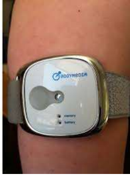
Şekil 3.4. Kola takılarak ölçüm yapan akselerometre.
