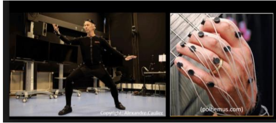
Görsel 35. Elektromanyetik hareket yakalama teknolojisi
