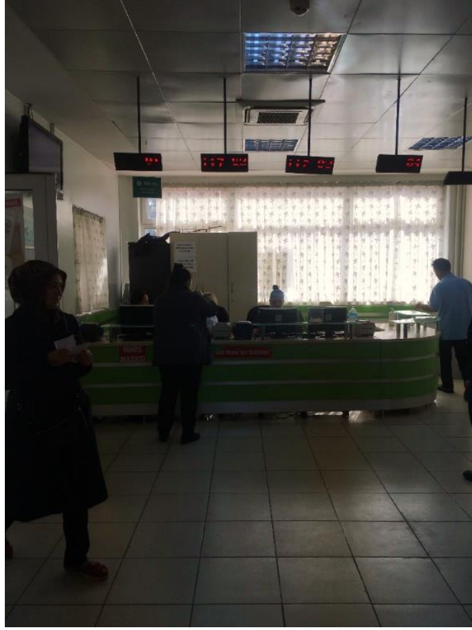
Görsel 90. Dr. Sami Ulus Çocuk Hastanesi bekleme alanında bulunan karşılama bankosunun pencere önüne yerleştirilmesi neticesinde oluşan verimsiz günışığı kullanımına örnek (Kişisel arşiv)
