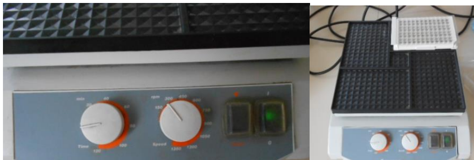
Şekil 20. Elisa kitlerine eklenmiş örnekler 200 rpmde önerilen inkübasyon süresince karıştırılması.
