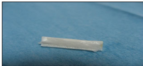
Resim 3.2 PHB ve chitosan modifikasyonu ile tüp şeklinde hazırlanmış greft materyali
