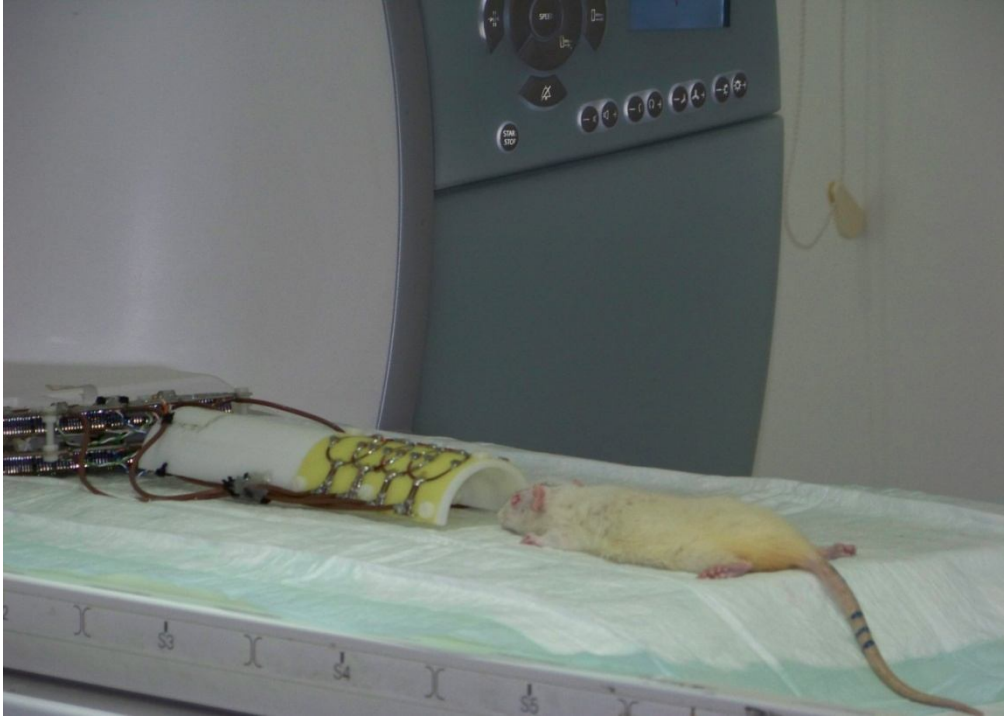
Şekil 3. 4. Anestezi altındaki sıçan ve sıçan için geliştirilen sarmal.
