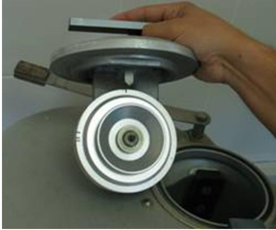
Şekil 3.2. Burkard spor ve polen tuzaklama aracının içindeki kasağın şeması.
