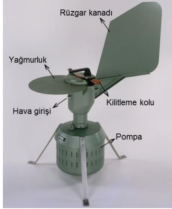
Şekil 3.1. Burkard spor ve polen tuzaklama aracının genel görünüşü.
