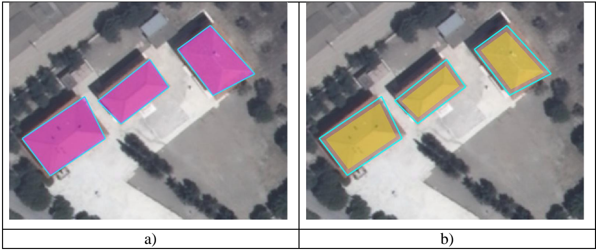
Şekil 3.27. Çatılan bina sınırlarından a) poligon oluşturma, b) başlangıç tohum alanları için tampon bölge oluşturma
