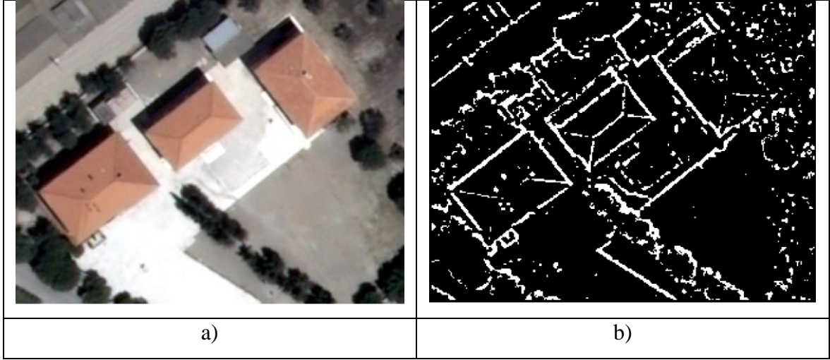
Şekil 3.16. TA_1 test alanına ait a) renkli ortofoto, b) DoG filtresi ile elde edilen kenar görüntüsü
