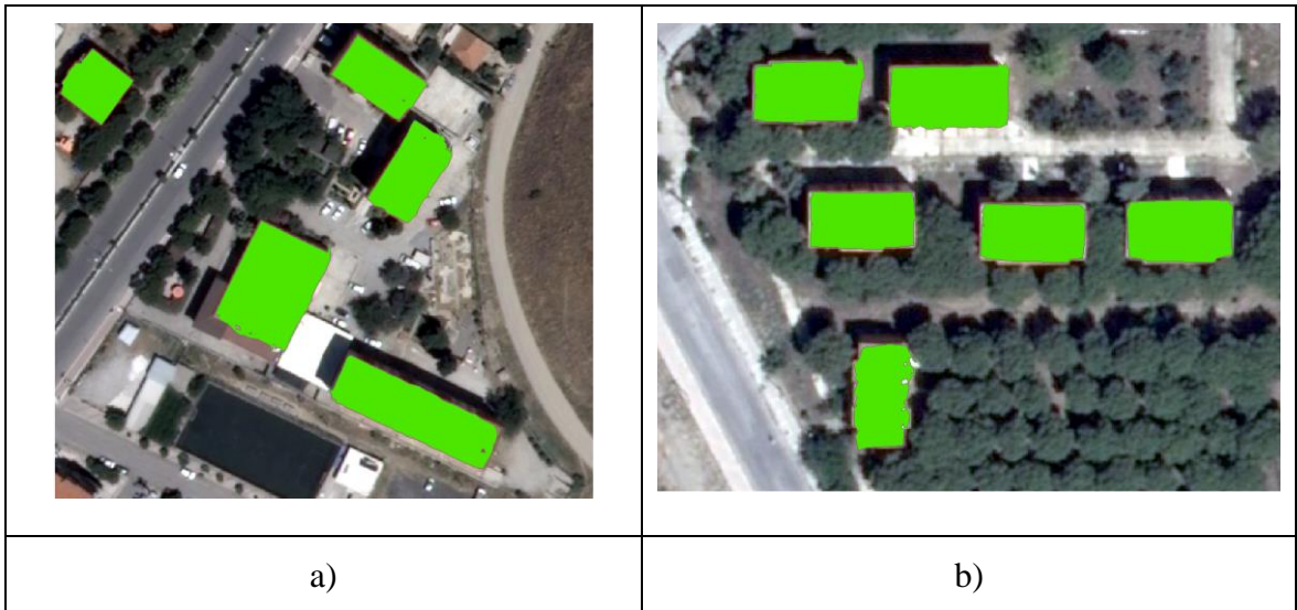
Şekil 4.15. Kombine yöntem ile belirlenen binalar: a) TA_3 test alanında belirlenen binalar, b) TA_5 test alanında belirlenen binalar
