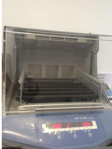
Şekil 3.8 Adsorpsiyon çözeltilerinin hazırlandığı inkübatörlü karıştırıcı sistemi
