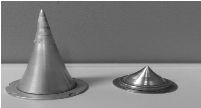
Şekil 1.3. Farklı enerjiler için tasarlanmış düzleştirici filtreler
