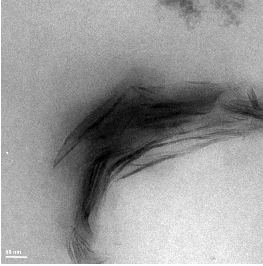
Şekil 4.25. SEBS/PP/Yağ-%5 Na-MMT kompozit örneğinin TEM görüntüsü.
