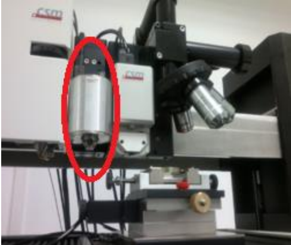
Şekil 3.3. Optik mikroskop, nano sertlik cihazı, afm cihazı ve mikro çizik testini bünyesinde barındıran açık platform.
