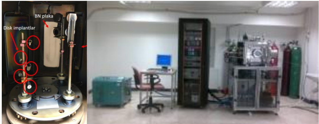
Şekil 3.1. a) Cihaz içinde kaplama yapılan implantlar ve BN plaka b) Vaksis RF-manyetron püskürtme sistemi
