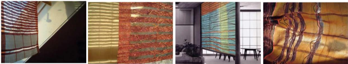
Resim 36. Termostriktif Akıllı Malzeme, Şekil Hafıza Alaşım Telleri (Ritter, 2007).
