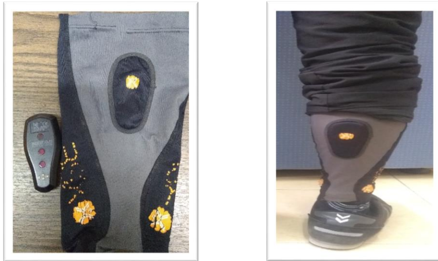
Şekil 3.5. a) Giyilebilir laktat eşiği tahmin cihazı ve (b) Giyilebilir laktat eşiği tahmin cihazının içerdiği kompresyon çorabı ve yerleşimi,
